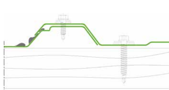
Längsstoß mit Wasserfalle
